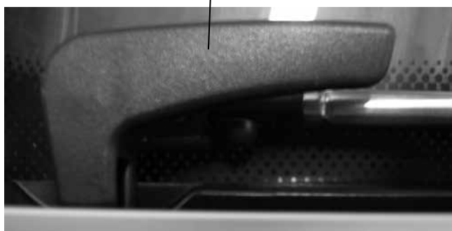
Vridreglage låsning fönster
