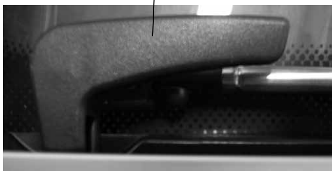
Vridreglage låsning fönster
