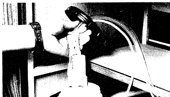
Polarvagnen är utrustad med elvattenpump. Kapacitet 5 liter/minut. Effekt 10—12 W. Spänning 12 V.
