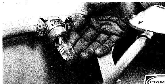
Gasolläckagetestarens plastbehållare fälls upp i vågrätt läge vid test. Om det börjar bubbla i vätskan är det läckage någonstans i gasolsystemet. Laga felet innan gasolsystemet åter tas i bruk.
