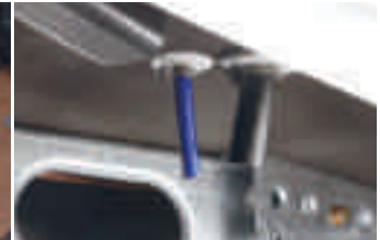
Gråvattentankens utvändiga avloppskran
