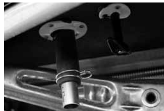
Gråvattentankens utvändiga avloppskran
