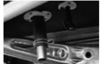
Gråvattentankens utvändiga avloppskran
