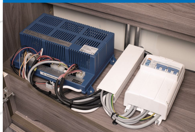
Kraftfull strömförsörjning inkl. laddmodul, huvudbrytare med nivåvisning för färskvatten
