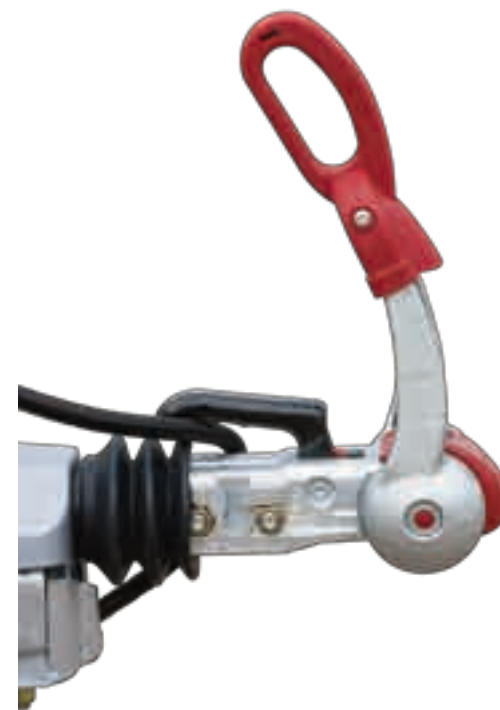
Genom friktionsbelägg som pressar mot bilens dragkula ger AKS säkerhetskoppling en stabiliserande effekt.
