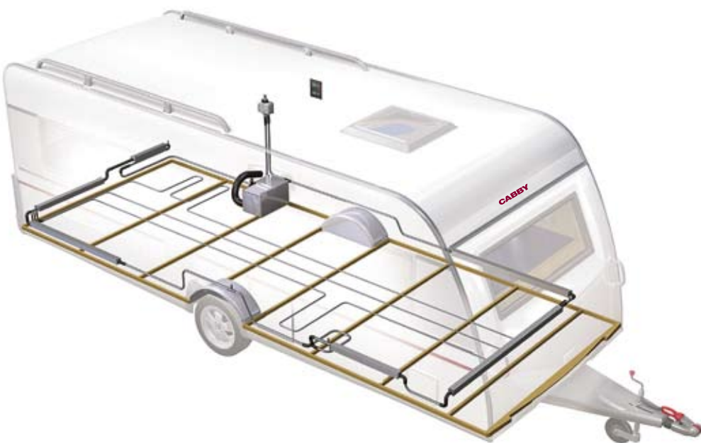
Vämeolvets slingor blir extra effektiva då värmeplåtar i golvet fördelar ut värmen jämnt och skönt.
