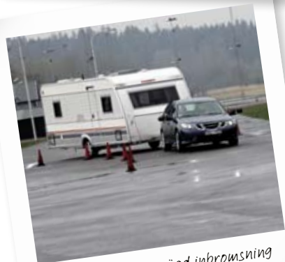
Genom en väl avvägd inbromsning av vagnen sträcks ekipaget ut och
