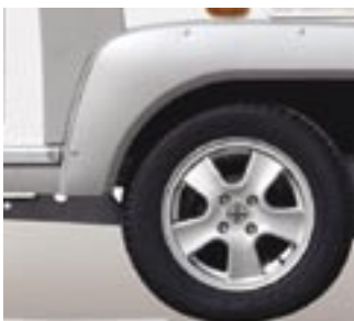
Aluminiumfälgar med åttalagers kvävefyllda däck och AKS säkerhetskoppling.
