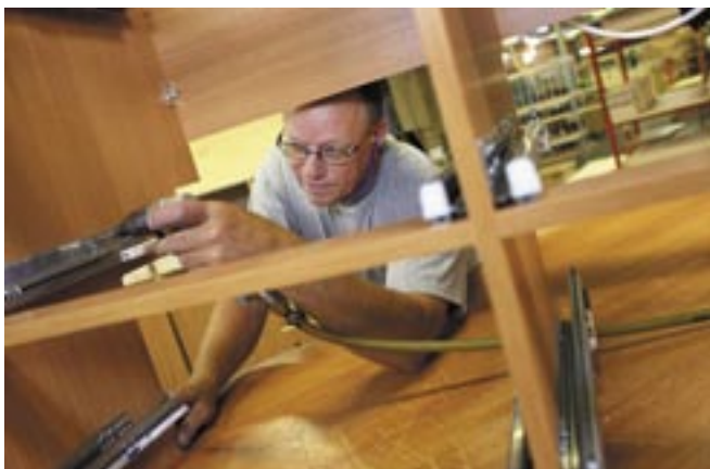
Hantverk i varje detalj. Här monteras lådorna med soft-close i köksdelen.
