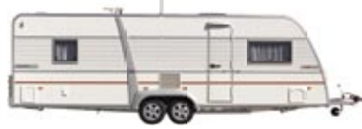
Åter dags för en helt ny vagn. En ny kaross där träreglar på utsatta ställen bytts ut mot polyurethanreglar.
