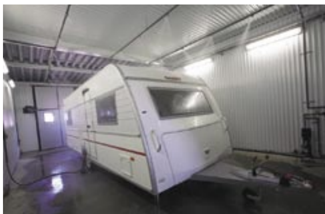
Alla vagnar utsätts för ett obarmhärtigt "spöregn" för att kontrollera tätheten.
