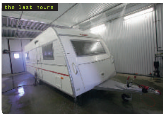
Ett vått eldprov. I ett par timmar ställs varje Cabby i ett konstgjort spöregn. Därefter gör vi ett fukttest på insidan. På så sätt kan vi vara säkra på att våra vagnar lämnar fabriken helt täta.
