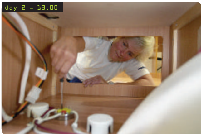
Day två, kl 13.00 – Hantverk i minsta skrymsle. I nya Cabby går alla kablar inne i den torra vagnen. Dessutom har vi i år en ny sorts kopplingsblock som är speciellt framtagna för Cabbys nya modell. Även bakljus och positionsljus har kablar dragna in i vagnen.
