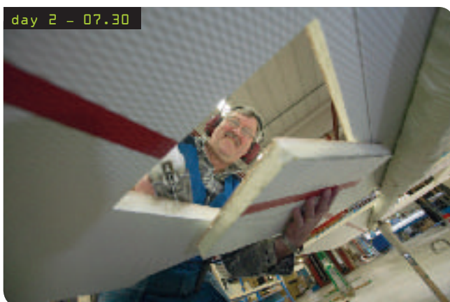
Dag två, kl 07.30 – Peter har håltimme. Peter precisionssågar ut hålen för bland annat fönster och dörr. Nu är det dags att montera väggarna på underredet.
