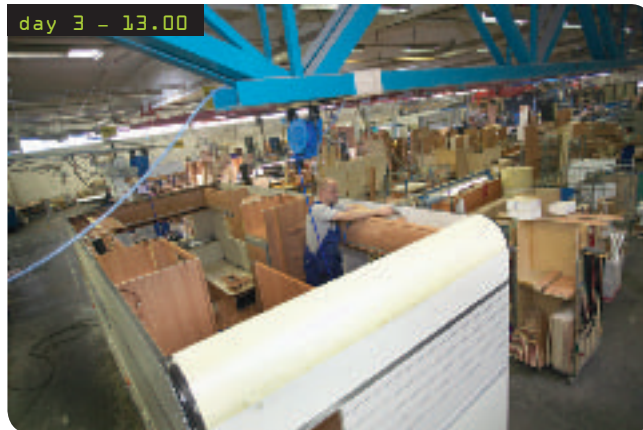
Dag tre, kl 13.00 – En Cabby-cabriolet. Innan taket monteras skruvas inredningen på plats. Årets modeller har en nydesignad insida med mängder av smarta lösningar för att utrymmet ska kunna utnyttjas maximalt.
