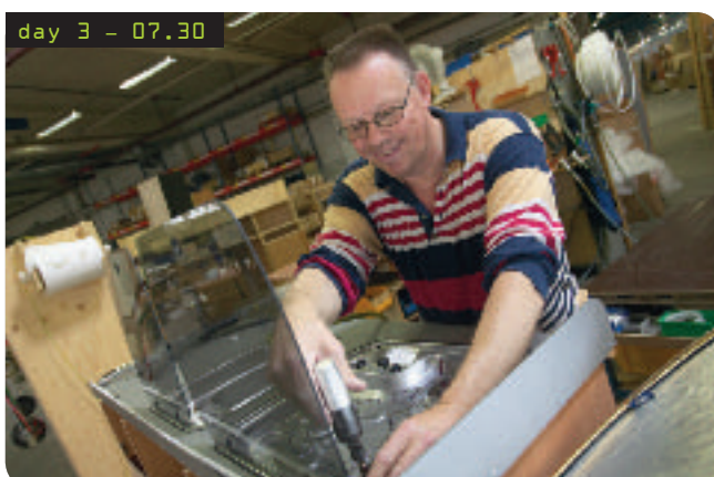
Dag tre, kl 07.30 – Kökspersonalen gör sitt jobb. Den effektiva gasolspisen skruvas fast över de skåp och lådor som därefter lyfts in i den halvfärdiga husvagnen. Kylskåpet passas in och integreras i Cabbyn.
