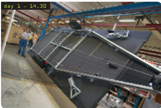
Day ett, kl 14.30 – Cabby's vändpunkt. Allt på undersidan av chassiet är klart. Nu väntar montering av väggar och tak. Men innan dess ska den viktiga isoleringen göras.
