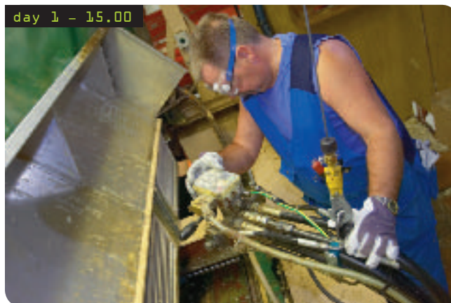
Day ett, kl 15.00 – Det unika med Cabby är välisolerat. I många framgångsrika år har vi använt oss av polyurethanskum som isolering. Materialet passar perfekt som isolering eftersom det inte drar åt sig fukt. Karossen är självbärande och därför behövs heller inga regler eller andra förstärkningar. På så sätt undviker man kallras och köldbryggor, samtidigt som värmen kan hållas kvar inomhus vid riktigt kalla dagar. Innerväggen i plywood och ytterplåten placeras i pressen och polyurethanet sprutas in under högt tryck. Därefter får allt stelna till en kompakt och välisolerande fyllning. Vi kallar det här effektiva sättet att isolera en husvagn för Cabby-metoden.
