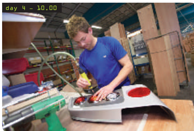
Dag fyra, kl 10.00 – Lysande detaljrikedom. Här sätts de sista detaljerna fast på den nästan färdiga vagnen. Lister passas in, positionsljus och baklyktor skruvas fast och emblemen sätts på plats.
