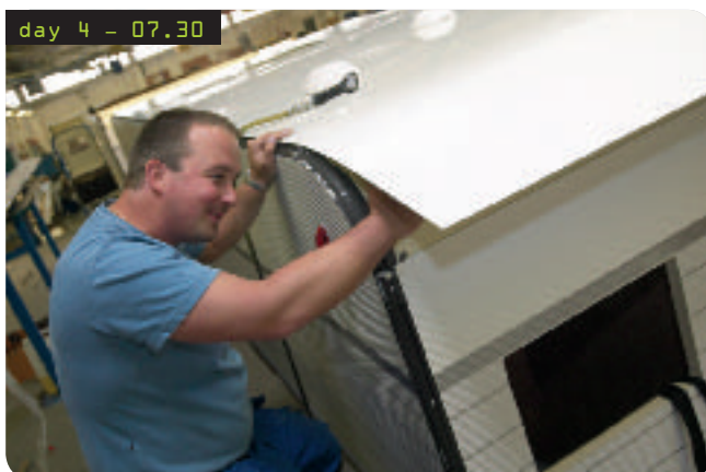
Dag fyra, kl 07.30 – Nu lägger vi locket på. Takplåten passas in över det välisolerade taket. På insidan är det mesta färdigt.
